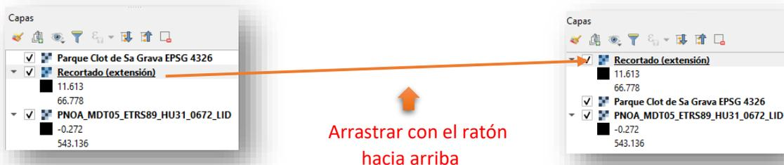
Ahora vemos en pantalla el trozo cortado del MDT05 en escala de grises, cada pixel representa un espacio de terreno 5mx5m con un valor de altura sobre el nivel del mar que lo vemos en pantalla con un valor de tono de gris (blancos= mayor altura, negros = menor altura)...
