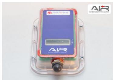
**Estaciones BS11-BS:** solamente se pueden utilizar con tarjetas SIAC. Registran el paso a una distancia de hasta **180cm** de la estación. La estación no registra el paso de la tarjeta en su memoria, solamente la tarjeta guarda la información.
